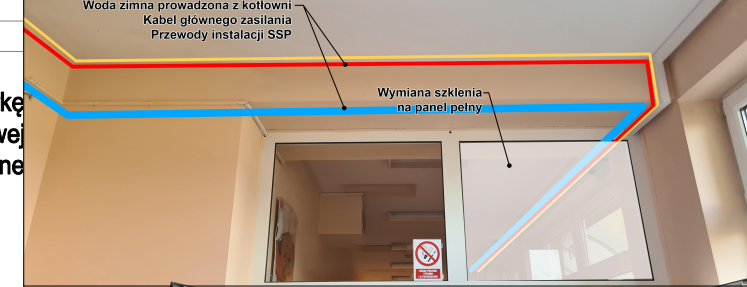
Panel SP.D.Alu.1 Wizualizacja przejścia rurami przez stolarkę aluminiową
